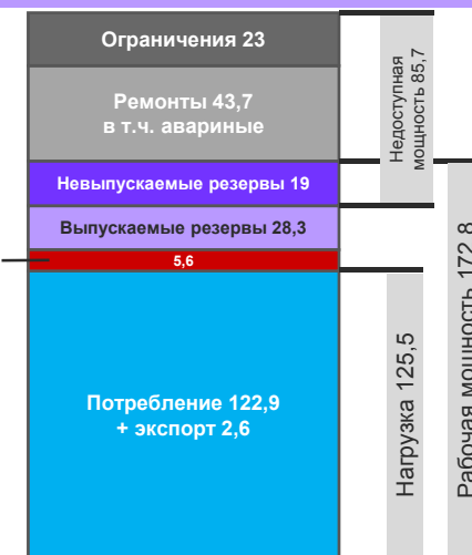
Структура мощности на час зимнего максимума 2016 г. в ГВт, данные АО «СО ЕЭС»
